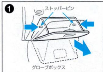
グローブボックスを両側から押さえてストッパーピンが外れるとグローブボックスも外れます。
