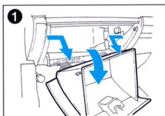
グローブボックスを開き、両側から押さえてストッパーを外して、グローブボックスを外します。
