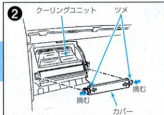
クーリングユニットのカバーを取り外します。(カバーは左右のツメを掴みながら引き抜きます。)
