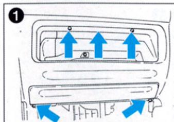
上図の矢印5ヶ所の⊕ネジを外します。
