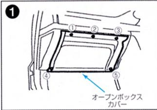
オープンボックスカバーの上下5ヶ所のネジを取り外します。
