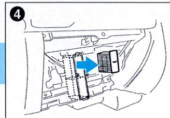
古いフィルターを上側から引き出し、次に下側のフィルターを取り出します。(上下2個で1セットです)
