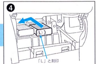
2個セットのうちカバー部に「L」と刻印されているフィルターを先に入れ、左にスライドさせ、次に刻印なしのフィルターを取り付けます。
