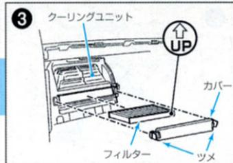
フィルターをクーリングユニットに取り付けます。\*フィルターの上下を間違えますと、エアコンの風量が落ちることがありますので、取り付けの際はUPマークの向きに合わせて取り付けてください。クーリングカバーはツメがカチッと音がするまで押しこみます。
