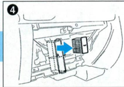
4 古いフィルターを上側から引き出し、次に下側のフィルターを取り出します。(上下2個で1セットです)
