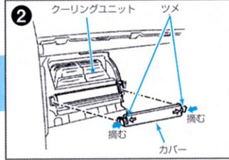
クーリングユニットのカバーを取り外します。(カバーは左右のツメを揃えながら引き抜きます。)
