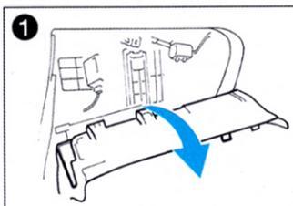
クリップを外してから、グローブボックスを外します。
