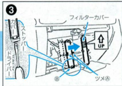
3 ツメA部を外側から押して外し、B部をドライバー等で下から押し上げ、カバーを外します。
