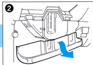
⊕ネジ2ヶ所を外して、アンダートレイを外します。
