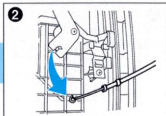
内外気切替ワイヤーの先端を外します。
