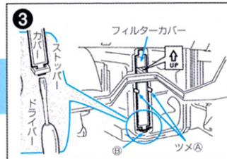
ツメA部を外側から押して外し、B部をドライバー等で下から押し上げ、カバーを外します。
