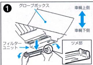
グローブボックス下にあるフィルターカバーの両側のツメ部分を外して(手前を先、奥を後)、カバーを取り外します。
