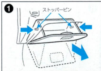
1 グローブボックスを開き、両側から押さえてストッパーを外して、グローブボックスを外します。
