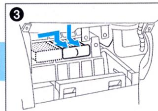
右側のフィルターから外し、外す際は手前部分を下に下げながら引き出します。
