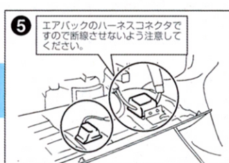
5 エアバックのハーネスコネクタですので断線させないように注意してください。 ランプとエアバッグのコネクタを外します。断線に注意してください。
